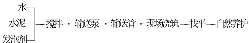
图5.2.3-2 化学发泡工艺图
